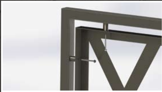
montaż z tulejami / assembly with sleeve
